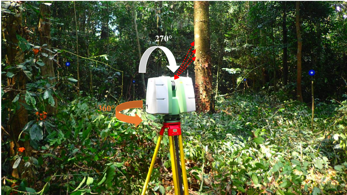
Fig. 6 : Disposition du scanner LiDAR terrestre C10 de Leica et des cibles en forêt.
