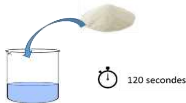
Figure 36 : Représentation schématique du test de mouillabilité.
