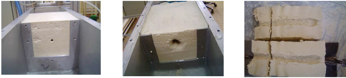
Figure 3-9. HET version n°1, exemple d'échantillon avant et après érosion.
