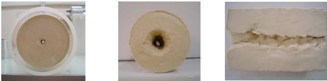
Figure 3-10. HET version n°2, exemple d'échantillon avant et après érosion.
