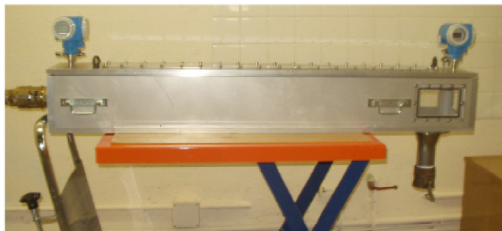
Figure 3-7. Hole Erosion Test version n°1 en 2004 par N. Benahmed et S. Bonelli (Cemagref)
