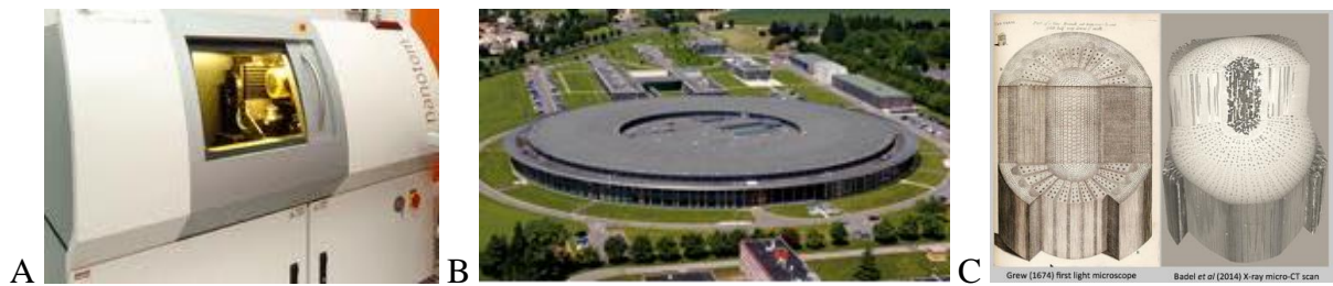
Figure 20 : Les outils de la microtomographie à rayon X. (A) Microtomographe à rayons X de laboratoire (modèle Nanotom, GE, disponible à l'UMR PIAF), (B) Synchrotron (ici, le synchrotron français SOLEIL disposant de 2 lignes de lumière pour la microtomographie, PSICHE et ANATOMIX). (C) Illustration de l'observation 3D d'une tige de Vitis par microscopie optique (à gauche, Grew 1674) et microtomographie à rayons X (Badel, 340 ans plus tard !).
