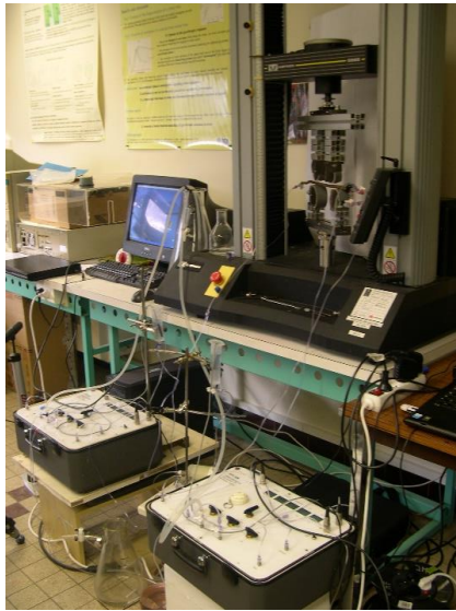
Figure 41 : Mise en évidence de l'existence d'un couplage hydrau-mécanique lors de la flexion d'un segment de branche. La flexion génère un pic de débit transitoire assimilable à une augmentation de pression au sein du système vasculaire.
