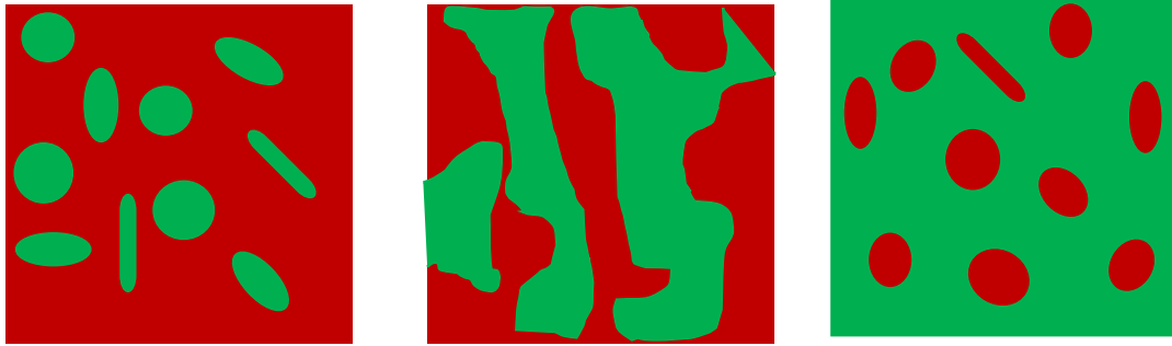
Figure 20. Évolution de la morphologie d'un mélange de polymères non miscibles, en fonction de la proportion de polymères.
