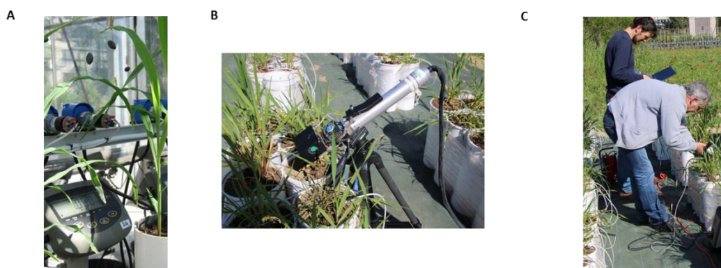
FIGURE 6 Mesures de trois traits foliaires au cours de la croissance végétative. (A) Poids attachés aux feuilles reliés aux transducteurs de déplacement rotatif dans PhenoDyn pour calculer l'élongation foliaire. (B) Mesure de la vitesse photosynthétique grâce à l'appareil portatif CIRAS. (C) Prélèvement des spectres sur les feuilles sélectionnées grâce au NIRS.
