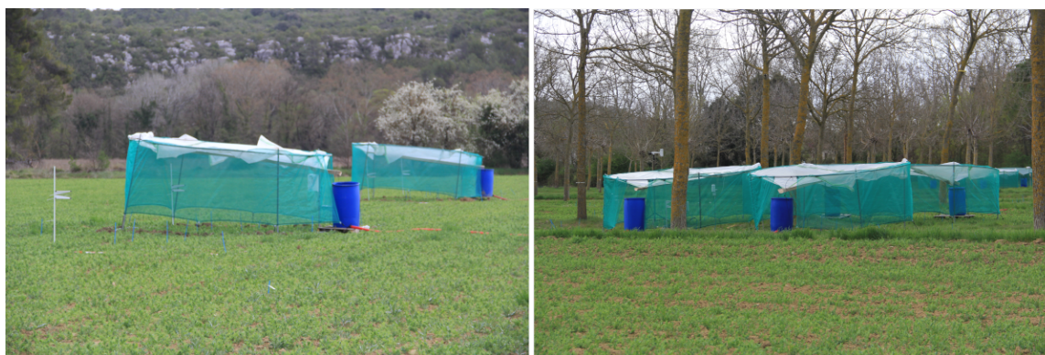
FIGURE I.2 Dispositifs d'exclusion de pluie d'envergure moyenne, en place juste avant un épisode pluvieux.
