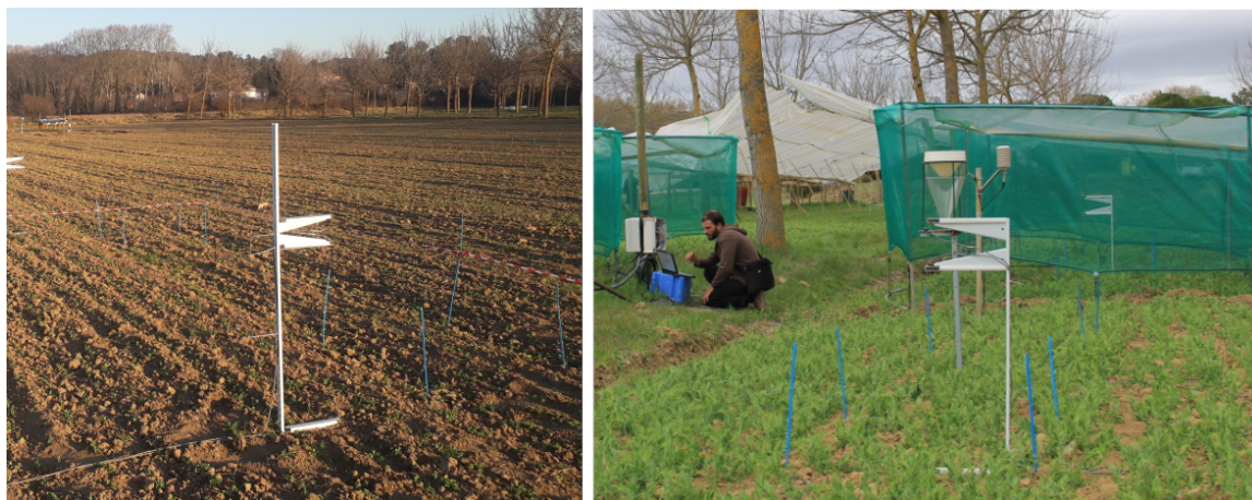
FIGURE 17 Capteurs PAR installés à la parcelle pour quantifier le flux de lumière incident et intercepté.
