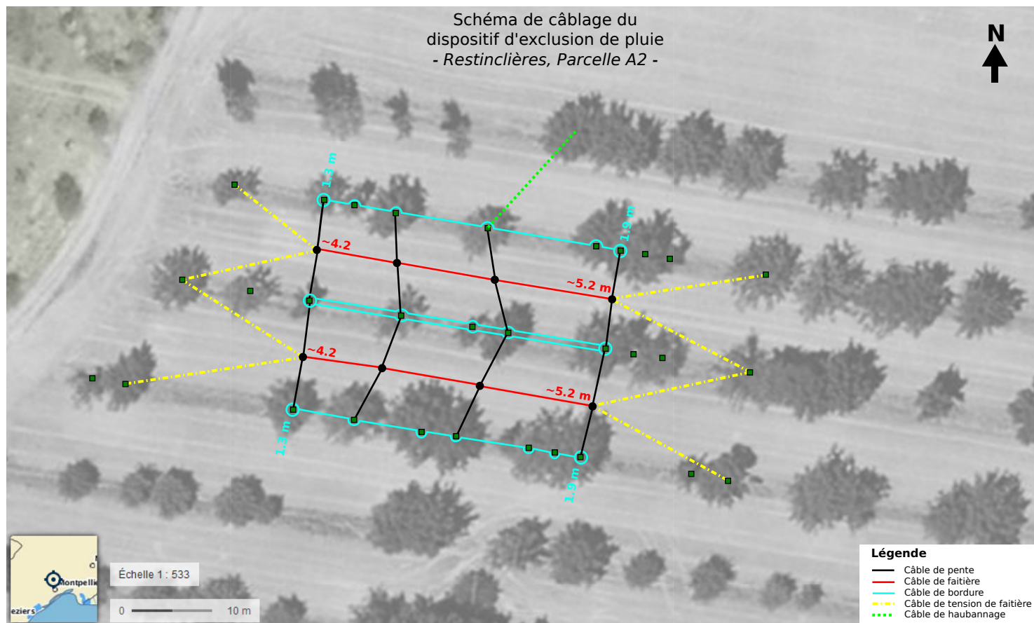
FIGURE C.4 Schéma global de l'implantation des câbles de structure du dispositif de grande envergure en agroforesterie
