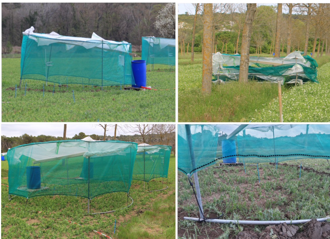
FIGURE C.8 Photographies supplémentaires des dispositifs de moyenne envergure. Les filets latéraux et la gouttière sont mis en tension à l'aide de tendeurs fixés sur les barres au sol. Lorsque les dispositifs sont rangés, les toits (composés du "cercle" d'arceaux supérieur, de la bâche translucide, de la gouttière et des filets latéraux) sont empilés sur la ligne d'arbre.
