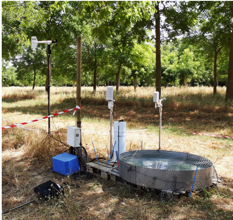
FIGURE 19 Bac d'évaporation de classe A installé en AF (bloc B) pendant la période estivale.
