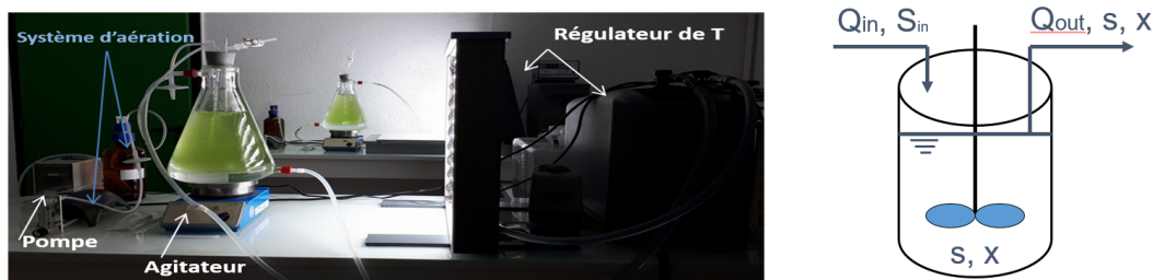
FIGURE 2.3 : Deux chemostats (photobioréacteurs en mode continu) mis en place au laboratoire pour le suivi de croissance des espèces étudiées – Schéma du chemostat
