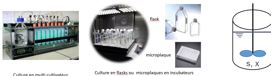
FIGURE 2.2 : Différents photobioréacteurs en mode batch utilisés pour le suivi de croissance des espèces étudiées – Schéma du batch
