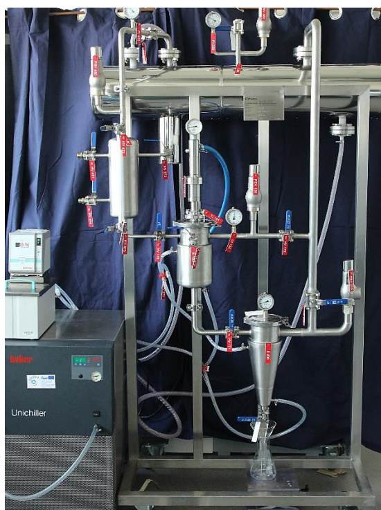
Figure I. 13 - Pilotes d'extraction par gaz liquéfiés d'une capacité de 1 Litre et 500 Litres (Plateforme d'Eco-Extraction de Valréas, France)
