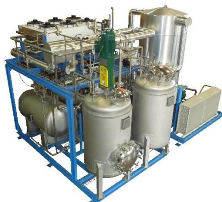
Figure I. 10 - Unité industrielle d'extraction de 500 litres fonctionnant selon un procédé isobare (crédits : Celsius s.a.r.l.)
