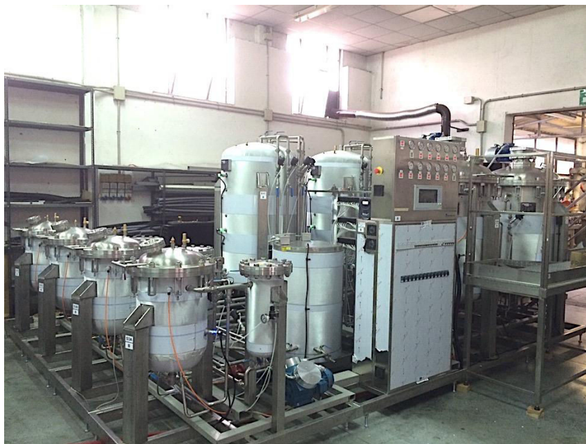
Figure 1. 14 - Unité d'extraction de 2000 Litres d'extraction de pyrèthre (crédit : TecnoLab S.r.l.)
