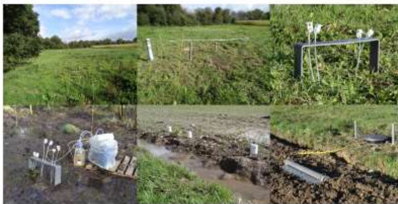
Zone humide de Guériniec, piézomètres et collecteurs d'eau du sol ou d'eau de ruissellement (bas à droite) (Dupas, 2016)
