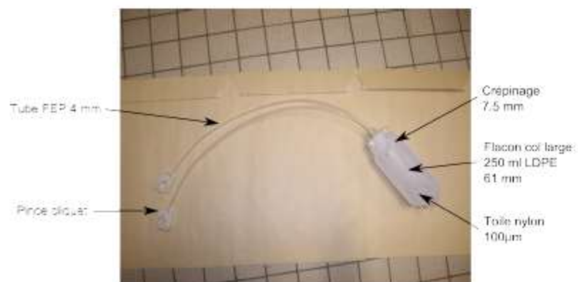
Figure 4 : dispositif de prélèvement de la solution du sol (Humbert, 2015)
