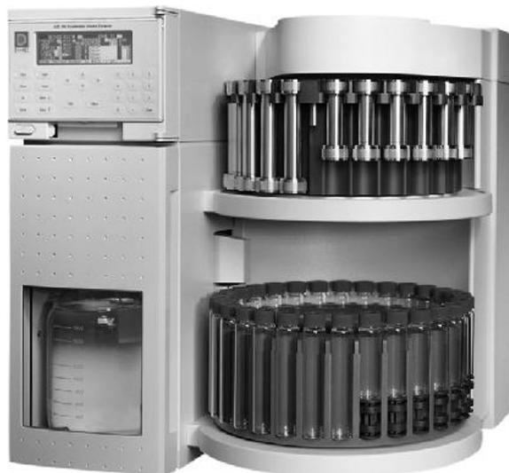
Figure 41: Photographie de l'appareil ASE 200 system de Dionex
