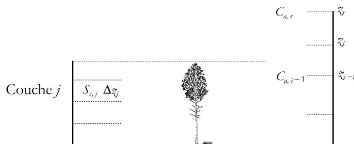
Figure 1.2.2 : représentation des densités de sources/puits et des profils de CO_2 par valeurs discrètes.
