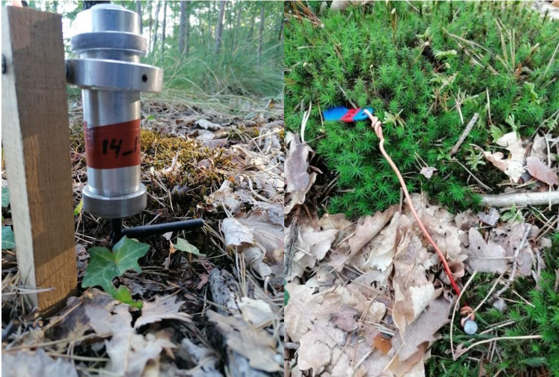
Photo 3 - A gauche, installation d'un capteur de lumière auto-nivelant au-dessus d'un tapis de Polytrichum formosum . A droite, installation d'un thermo-hygromètre, attaché pour éviter le déplacement ou la perte du capteur, dans un tapis de Polytrichum formosum .
