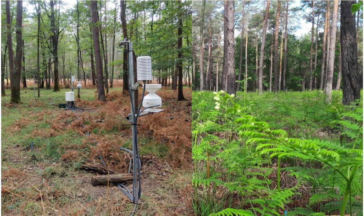
*Photo 2 - A gauche : station météorologique, regroupant la centrale d'acquisition et les capteurs de lumière et d'humidité, installée sur une placette ouverte en mélange (Photo C. Couteau). A droite : placeau de régénération en placette ouverte en pur pin pendant les suivis de régénération 2019 (Photo L. Chevaux).*
