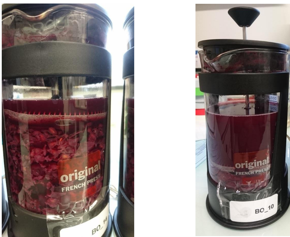
Figure 47. Dispositif de microvinification dans une cafetière à piston. A gauche, en cours de fermentation alcoolique avec le marc immergé, à droite avec le piston baissé pour simuler un pigeage une fois par jour.
