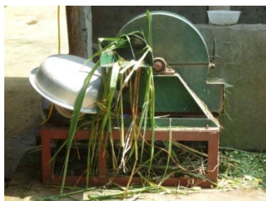
Figure 14. Broyeur de cannes fourragères et pot trayeur mécanique dans des exploitations laitières au Vietnam
