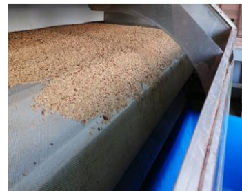
Figure 2.10 : Déshydratation des co-produits de pressage des graines de grenade avec un sécheur à tapis industriel en continu.
