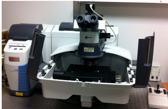
Figure A20 microspectrophotomètre Raman de la ligne SMIS
