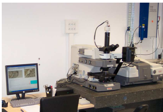
Figure A19 microspectrophotomètre infrarouge de la ligne SMIS
