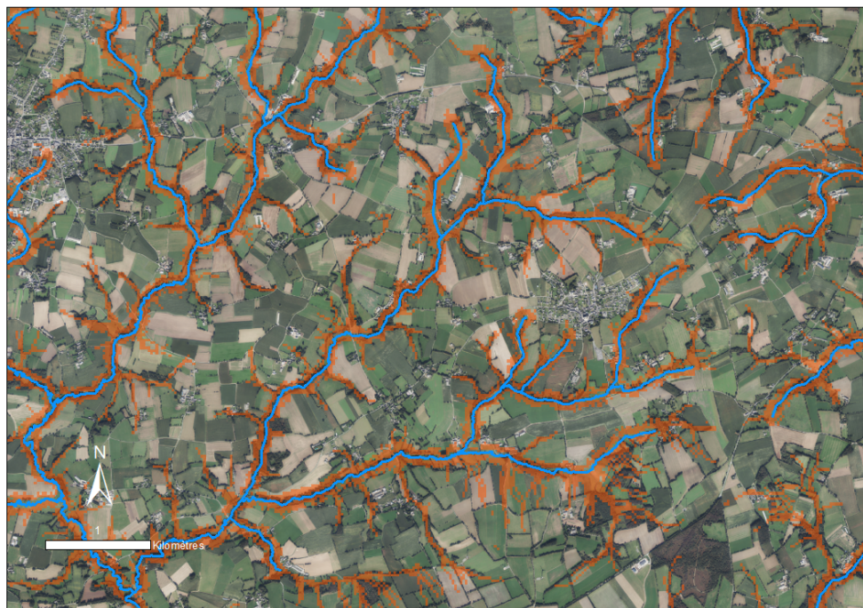
FIGURE 4.9 – Exemple de cartographie des critical source areas (CSA en orange) pour le phosphore, pour un bassin versant breton. On observe que les CSAs correspondent aux zones proches du cours d'eau et aux zones d'accumulation de flux.
