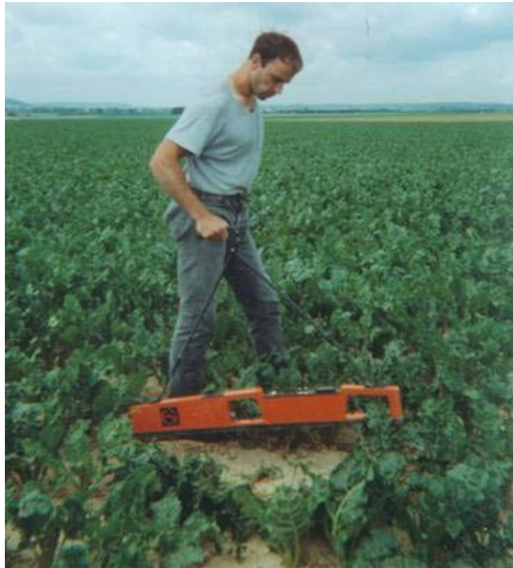
Figure IX.2. Mise en œuvre du conductivimètre EM38 sur la parcelle expérimentale de Chambry.
