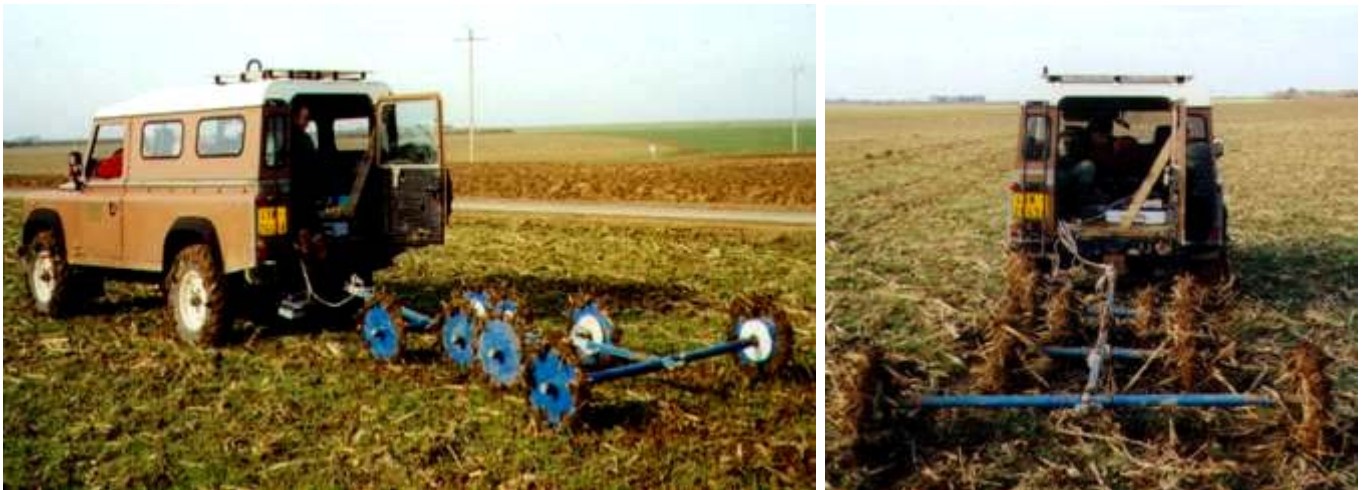
Figure IX.5. Photographies du système MUCEP lors d'une prospection en Petite Beauce .
